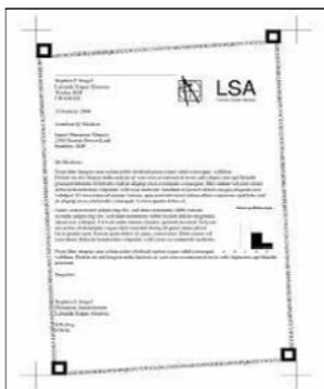
Figure 1 - Modèle de test utilisé dans la norme **ISO/IEC19752**
